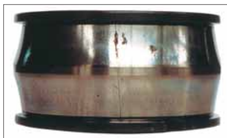
Pękanie pierścienia wewnętrznego
